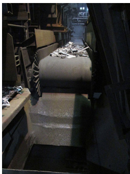
Przenośnik taśmowy w obszarze zsypu wyładowczego (tutaj z dwóch różnych perspektyw). Zdjęcia wyraźnie pokazują, że warunki pracy w tym miejscu są bardzo trudne.
