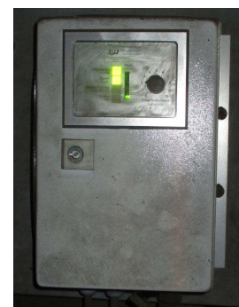
探测器线圈的响应特性可通过评估单元进行设置。
