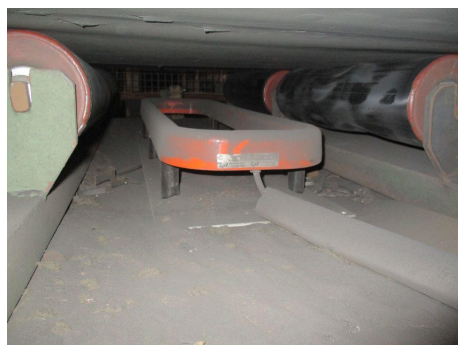
输送带下的检测线圈由 PVC 柱安装在铝制底板上，可屏蔽来自底层结构的电磁干扰。这一设计还确保了安装的稳定性。
