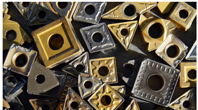
Bei der Zerspanung sind Wendeschneidplatten für die Metallbearbeitung hohen mechanischen Beanspruchungen ausgesetzt, wie diese gebrauchten Werkzeuge zeigen. Die „Rezeptur“ für die Schneidstoffe ist daher, abgesehen vom zu bearbeitenden Material, entscheidend für lange Standzeiten. (Bild: Adobe Stock)
