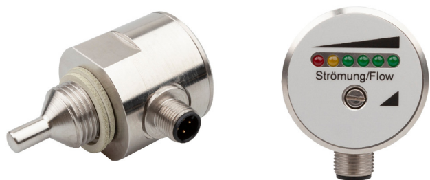
Ein Blick auf die LED-Anzeigen genügt, um festzustellen, ob ein ausreichender Durchfluss vorhanden ist oder nicht. Der robuste SS410124 von ipf electronic ist für Medientemperaturen bis +80° C ausgelegt und druckfest bis 100bar. Gehäuse und Messfühler sind aus Edelstahl 1.4571 und verfügen über die Schutzklasse IP67. Der Durchflusswächter arbeitet nach dem kalorimetrischen Prinzip und ist absolut verschleißfrei.
