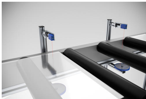
Detección de cristales transparentes que se transportan sobre una vía de rodillos. La altísima permeabilidad del vidrio a la radiación visible e infrarroja no causa problemas en este caso, ya que el material es resistente a la radiación UV del OR270478 no tiene permeabilidad.
