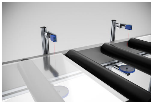
Rilevamento di lastre trasparenti trasportate su una rulliera. L'elevatissima permeabilità del vetro alle radiazioni visibili e infrarosse non crea alcun problema in questo caso, poiché il materiale è resistente alle radiazioni UV del OR270478 non ha permeabilità.
