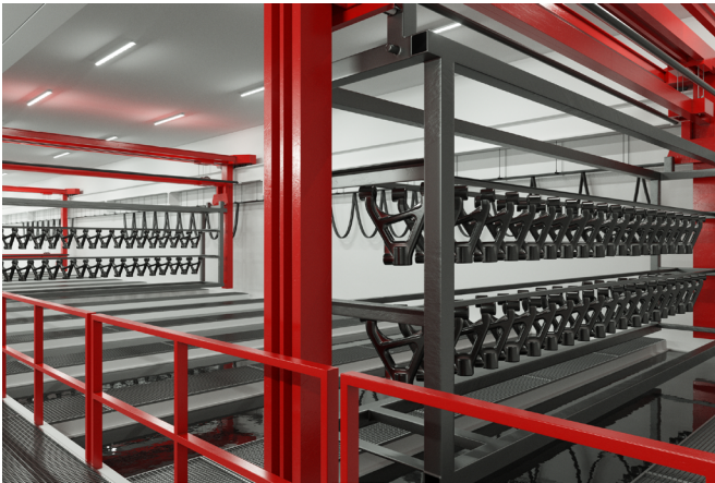
Die gesamte KTL benötigt insgesamt 12 einzelne Prozessschritte und besteht aus mehreren großvolumigen, hintereinander angeordneten Becken. (Alle Bilder: ipf electronic gmbh)
