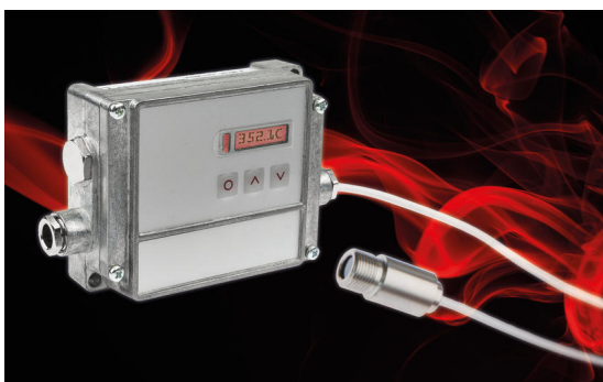
Měřicí hlava OI98C558 lze používat při teplotách okolí až do +180 °C. Systémové řešení včetně vyhodnocovací jednotky je vhodné zejména pro bezkontaktní měření teploty objektů s vysokým tepelným vyzařováním. (všechny obrázky: ipf electronic gmbh)
