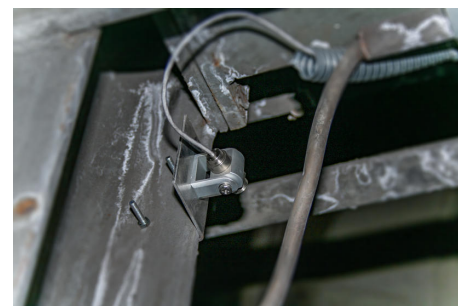
Per il montaggio e il facile allineamento delle teste di misura, la staffa AY98C075 che può essere facilmente regolata su due assi.
