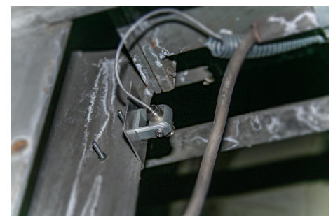
Para montagem e alinhamento fácil das cabeças de medição, o suporte AY98C075 que pode ser facilmente ajustado em dois eixos.
