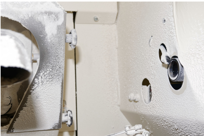
ipf electronic_Farbsensor_Weizen_Roggen-Mühle_003.jpg: Vorderseite des Farbsensors OF650180 mit einer Abblasvorrichtung, die die Optik von Mehlstaub befreit.
