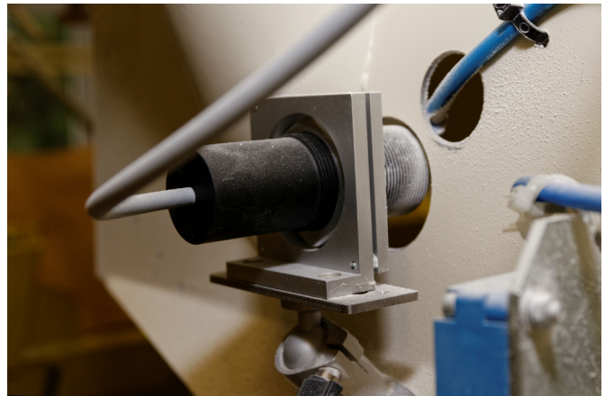
ipf electronic_Farbsensor_Weizen_Roggen-Mühle_004.jpg: Rückwärtige Ansicht der Anwendung: Für den Farbsensor wurde an einer Seitenwand der automatisierten Abfüllanlage eine Öffnung geschaffen.
