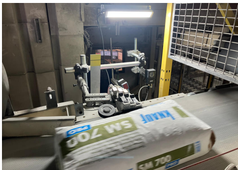
Eine Kompaktkamera der Reihe OC53 kontrolliert unmittelbar hinter dem Drucker lückenlos die Qualität der Kennzeichnung auf den Verpackungen mit Fertigprodukten. (Bilder: ipf electronic)
