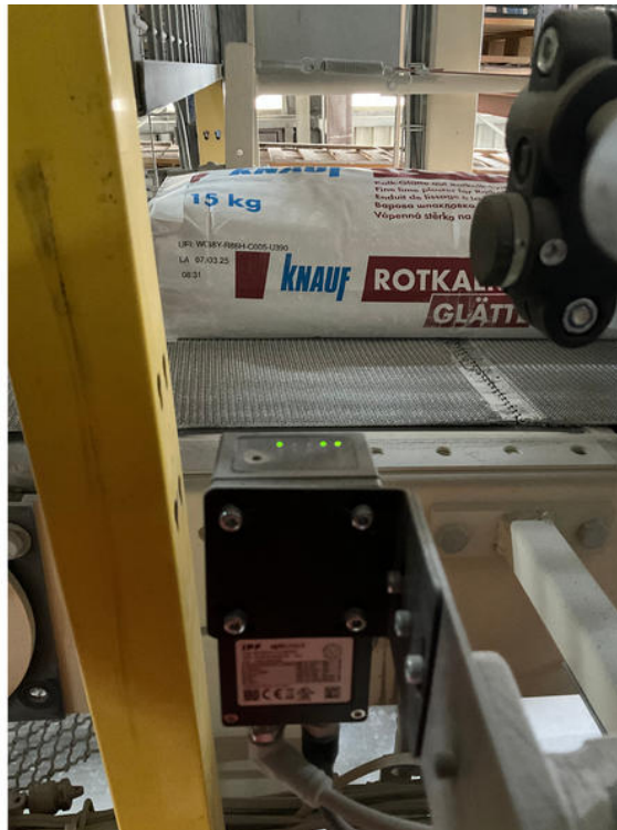
Durchschnittlich 1.500 Säcke pro Stunde werden je Fertigungslinie von den Kamerasensoren (ein Gerät im Vordergrund) geprüft. (Bild: Knauf Gips KG, Werk Lauterhofen)
