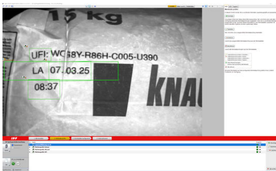
Durch das Merkmal „Lagenachführung“ wird sichergestellt, dass bei der Kontrolle der jeweils relevante Teil des Aufdrucks vollständig erfasst wird. (Bilder: Knauf Gips KG, Werk Lauterhofen)
