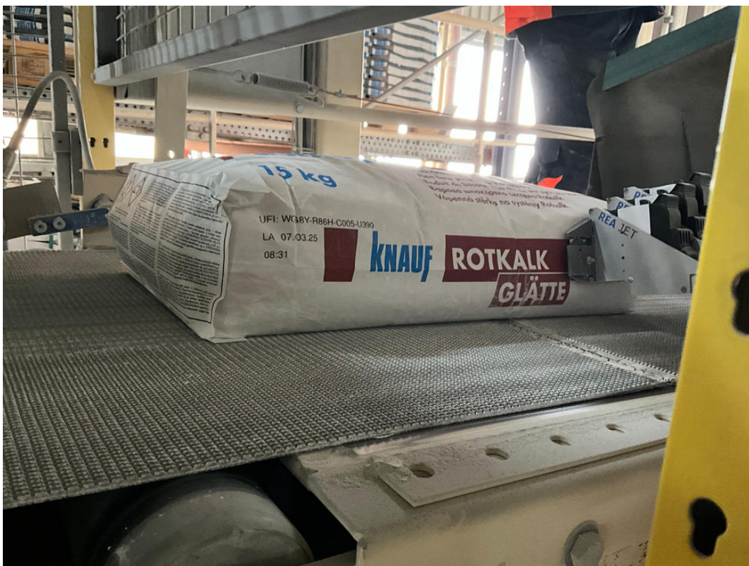
Die dreizeilige Kennzeichnung auf den Verpackungen umfasst den UFI-Code, das Kürzel des Werks Lauterhofen (LA), das Produktionsdatum und die Uhrzeit. (Bild: Knauf Gips KG, Werk Lauterhofen)
