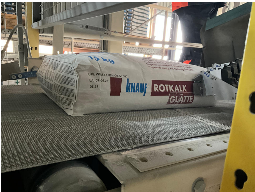
Le marquage de trois lignes sur les emballages comprend le code UFI, l'abréviation de l'usine de Lauterhofen (LA), la date de production et l'heure. (Photo : Knauf Gips KG, usine de Lauterhofen)
