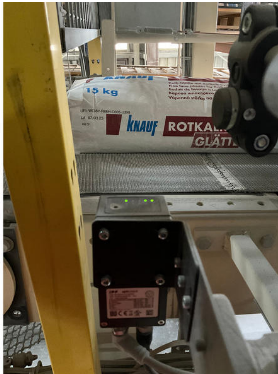
En moyenne, 1.500 sacs par heure sont contrôlés par les capteurs des caméras (un appareil au premier plan) sur chaque ligne de production. (Photo : Knauf Gips KG, usine de Lauterhofen)
