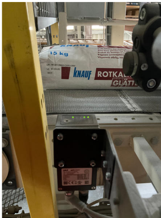
I sensori a telecamera (un dispositivo in primo piano) controllano in media 1.500 sacchi all'ora su ogni linea di produzione. (Immagine: Knauf Gips KG, stabilimento di Lauterhofen)
