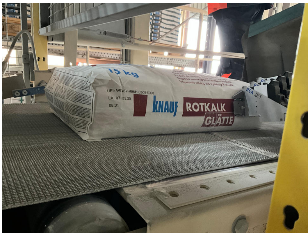
L'etichettatura a tre righe sulla confezione comprende il codice UFI, la sigla dello stabilimento di Lauterhofen (LA), la data e l'ora di produzione. (Immagine: Knauf Gips KG, stabilimento di Lauterhofen)
