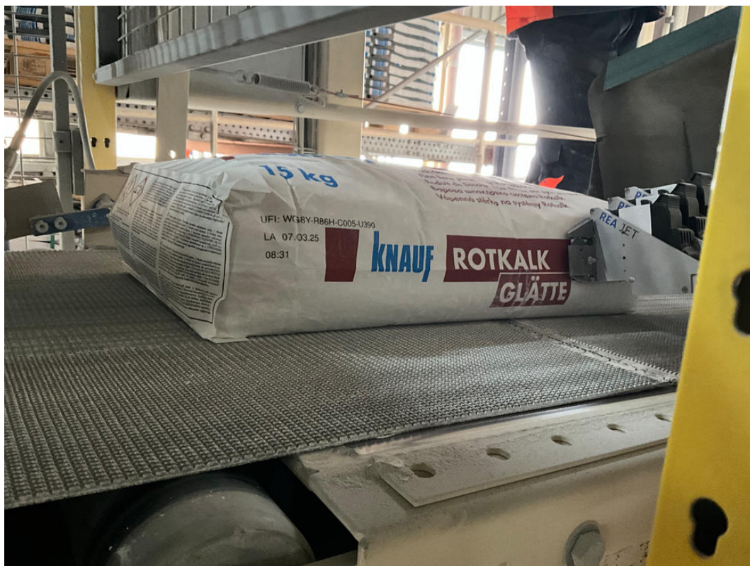
Trzywierszowa etykieta na opakowaniu zawiera kod UFI, skrót nazwy zakładu w Lauterhofen (LA), datę i godzinę produkcji. (Zdjęcie: Knauf Gips KG, zakład w Lauterhofen)
