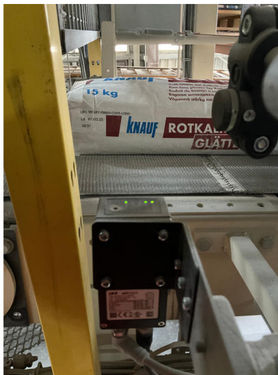
每条生产线上的摄像传感器 (前景中的一台设备) 平均每小时检查 1,500 个包装袋。
