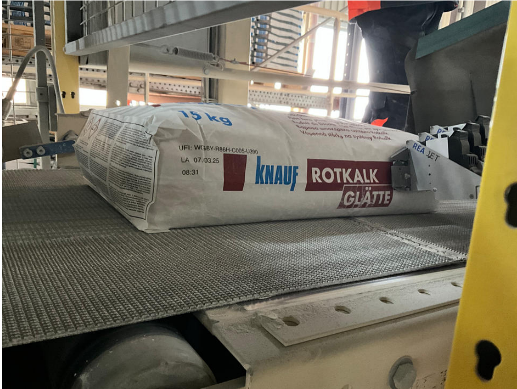
包装上的三行标签包括 UFI 代码、劳特霍芬工厂缩写 (LA)、生产日期和时间。(图片：可耐福吉普斯公司劳特霍芬工厂)
