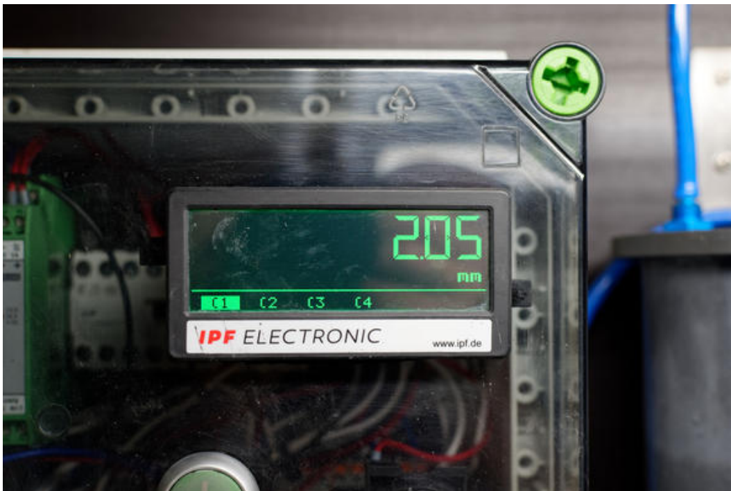
Monitor impulzů má v současné době čtyři lisovací rozměry (C1 až C4) pro záporné matice, které lze zvolit stisknutím tlačítka. Zařízení na čelním panelu vizualizuje aktuální rozměr pro předsun zelenými číslicemi. Po dosažení nastavené hodnoty hloubky matrice se zobrazení změní na červené. (Obrázek: ipf electronic)
