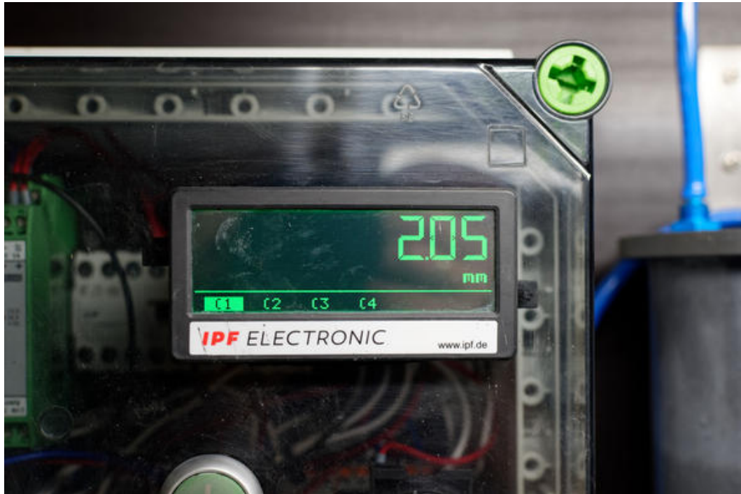
Quatre cotes d'emmanchement (C1 à C4) sélectionnables par pression de touche sont actuellement enregistrées dans le contrôleur d'impulsions pour les matrices négatives. L'appareil en face avant visualise la cote actuelle respective pour l'avancement avec des chiffres verts. L'affichage passe au rouge lorsque la valeur de consigne pour la profondeur de la matrice est atteinte. (Image : ipf electronic)
