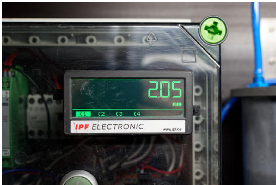
脉冲监控器目前有四种用于阴模的压入尺寸 (C1 至 C4)，可通过按键进行选择。前面板装置以绿色数字显示当前的进模尺寸。当达到模具深度的设定值时，显示屏将变为红色。(图片：IPF electronic)
