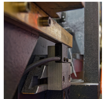
传感器 MW110430 安装在机器上，因此连接电缆不会磨损。磁尺位于传感器上方，磁尺与驱动装置相连，并通过附加的不锈钢条防止灰尘进入。(图片：ipf electronic)
