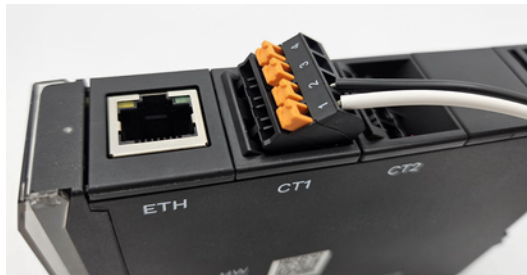
Anschluss eines NZ-Stromsensors am AB000008
