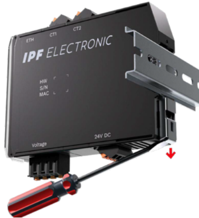
Demontage des AB000008 von der Tragschiene
