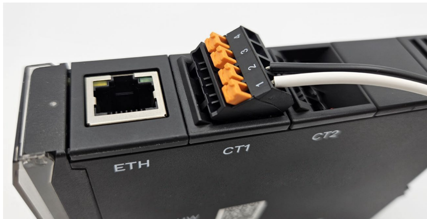
Anschluss eines NZ-Stromsensors am AB000008
