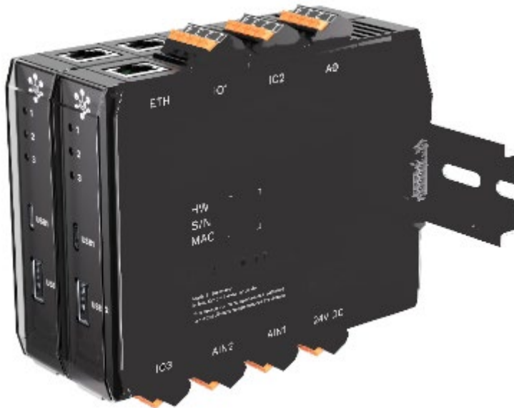
Abb. 4: Master-Gateway BY000002 mit einem AB000009
