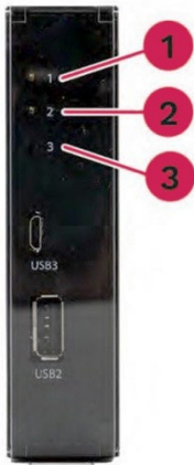
Abb. 3: LED-Statusanzeige an der Frontseite des AB000009
