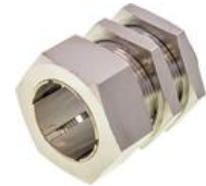
Zubehör Sensor, Klemmhülse, M22x1 34lang, Messing Weißbronze für Bauform M18
