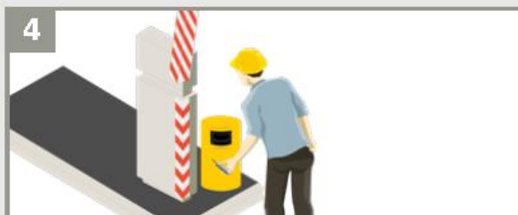
4 Die Position des Sensors verriegeln.
