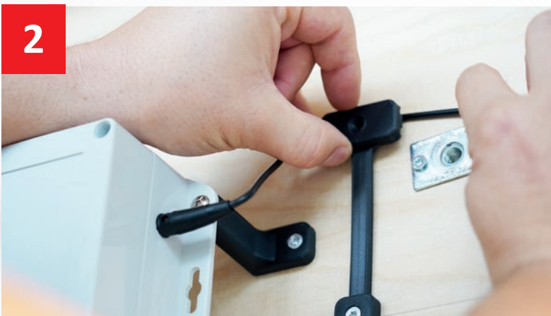
2 Elektroden mit Basisstation verbinden und mittels Elektrodenhalter befestigen
