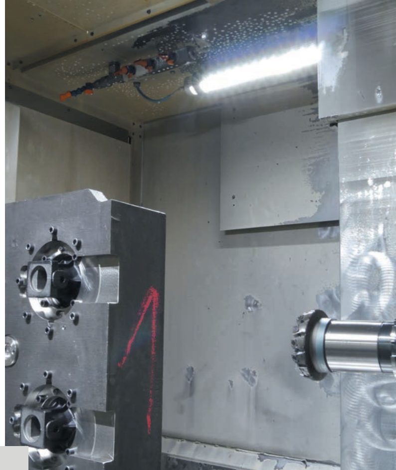
Ausleuchtung des Arbeitsraumes eines Bearbeitungszentrums
