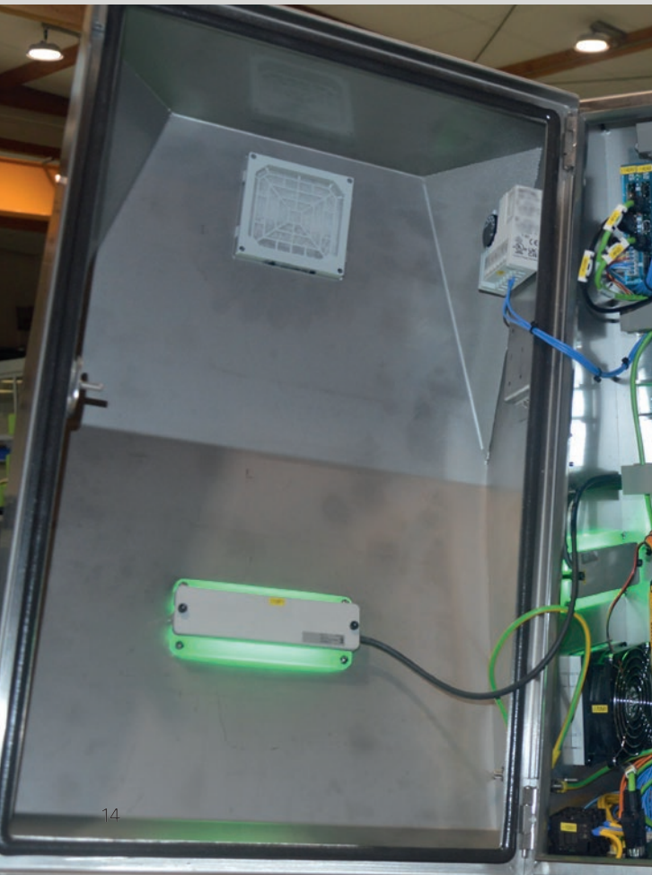
Firmenlogo als Statusanzeige an Entform-Handlings für Spritzgussmaschinen
