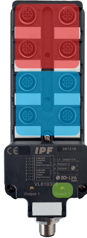
(Abbildung 2 mit farblicher Kennzeichnung: 8-fach-Logikmodul mit UND-Verknüpfung am Ausgang 2 für die Eingänge 5 bis 8. ODER-Verknüpfung für Eingänge 1 bis 4.)
