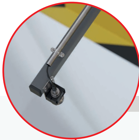
Materialschlaufenregelung an Bandanlage
