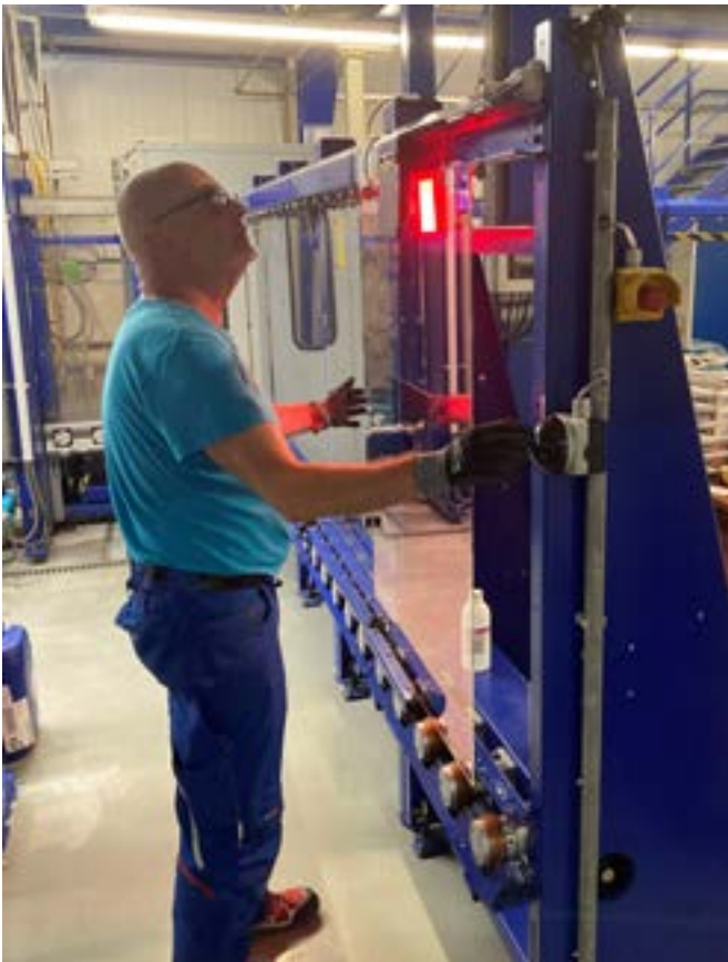
Insgesamt sind drei Kameras in der Anlage installiert. Die Abbildung zeigt den Bereich der Einschleusung. Dort werden die Substrate mit einem 2D-Code gekennzeichnet und über ein Kamerasystem unmittelbar verifiziert. (Prinz Optics GmbH)
