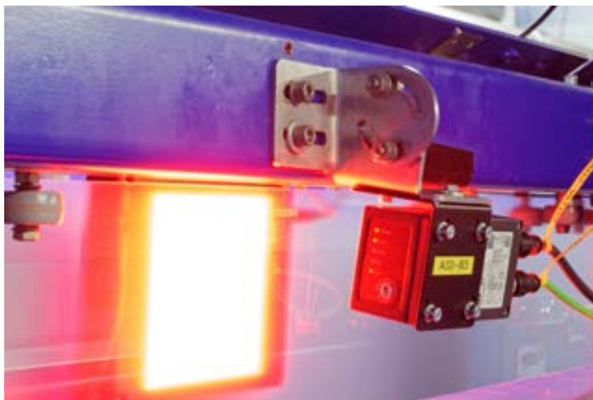
Einer der Kameras im Einsatz. Aufgrund von Durchlicht als Beleuchtungstechnik sind störende Reflexionen oder die Qualität der Beschriftung nicht mehr relevant für die zuverlässige Erkennung. (Bild: ipf electronic gmbh)
