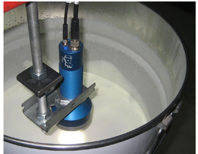
ipf_Schomburg_005: Der Farbsensor muss einen Abstand von genau 8 Zentimetern zum Produkt haben, um exakte Werte für die Farbkontrolle zu erhalten. Der Polarisationsfilter des Gerätes eliminiert das Reflexionsverhalten der flüssigen Bodenbeschichtung.
