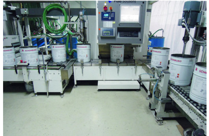
ipf_Schomburg_003: Die noch junge neue Automationslinie ermöglicht eine Produktfertigung in sehr flexiblen Mengen mit einer Taktzeit von drei Minuten.
