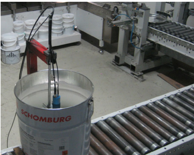
ipf_Schomburg_004: Der Farbsensor der Reihe OF34 von ipf electronic ist in der Testphase auf einer Halterung montiert. Sie wird später durch eine Hydraulikvorrichtung ersetzt, über die der Sensor zur Farbkontrolle automatisch in das Gebinde fahren soll.
