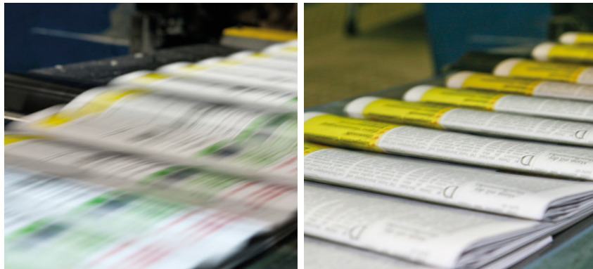
Scharfes Einzelbild einer High-Speed-Kamera in einer Druckerei (rechts).
