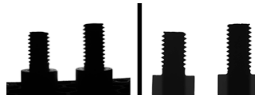
Aufnahmen von zwei Schrauben mit einem entozentrischen Objektiv (links) und einem telezentrischen Objektiv, durch das die Konturen des Gewindes exakt und somit verzeichnungsfrei dargestellt werden.
