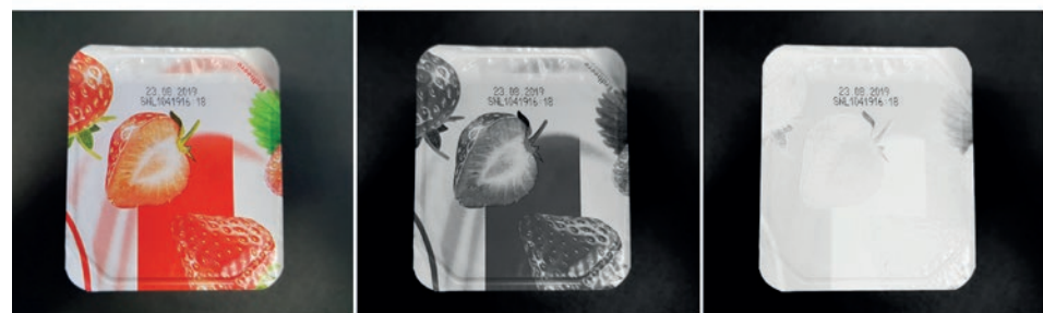
Abb. 18: Farbaufnahme (links) und Aufnahme eines Joghurtbechers mit einer Monochromkamera unter Weißlicht (Mitte). Mit Infrarotlicht wird das farbige Design bis auf die schwarze Beschriftung nahezu vollständig ausgeblendet (rechts).
