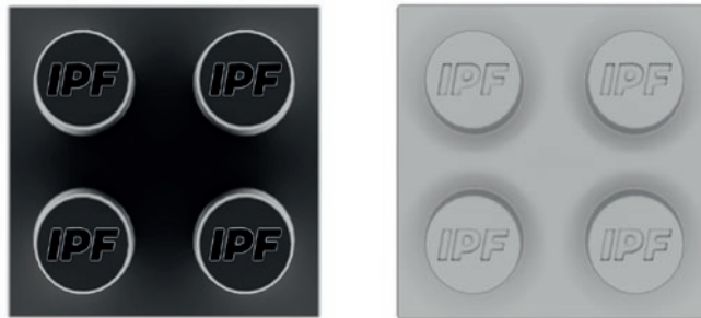
Abb. 10: Abbildung eines Klemmbausteins bei einer Dunkelfeldbeleuchtung (links). Im Vergleich hierzu der gleiche Baustein bei einer Hellfeldbeleuchtung (rechts). Die Konturen des Bausteins heben sich bei einer Dunkelfeldbeleuchtung kontrastreich zum Hintergrund ab.
