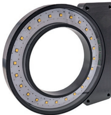
Abb. 22: Mit der ER1D7130 können Prüfobjekte aus unterschiedlichen Winkeln angeleuchtet werden, um deren dreidimensionale Eigenschaften zu beurteilen.
