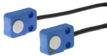
Sender und Empfänger der Ultraschallschranken UY210100 werden getrennt voneinander installiert und ermöglichen Reichweiten von bis zu 300mm.
