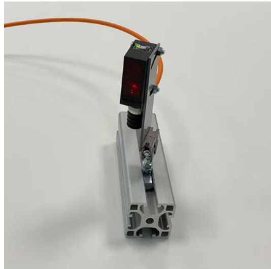
Tast-Reflexschranke ON450522 mit herausragenden Eigenschaften: Schaltfrequenz 2kHz, Ansprechzeit \leq 0,25\text{ms} und Reichweite bis 1000mm.
