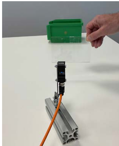
Der ON450522 benötigt keinen Reflektor, da das getaktete, punktförmige Rotlicht des Sendeelementes auf eine beliebige Referenzfläche, wie hier auf eine Transportkiste, eingestellt werden kann.
