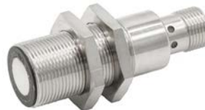
Ultraschalltaster wie der UT189520 lassen sich via IO-Link einfach zur Reflexschranke umschalten und daher auf einen Hintergrund anstatt auf ein Objekt einstellen, um bspw. transparente Objekte mit unregelmäßigen, runden oder schrägen Oberflächen sicher detektieren zu können.
