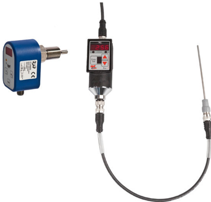
Einteiliger und zweiteiliger Temperatursensor für PT100 (von links). Die zweiteilige Ausführung mit separater Auswerteelektronik verfügt über verschleißfreie Transistor-Schaltausgänge (1A pro Kanal).
