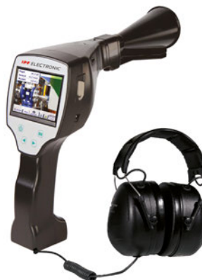
Das Leckagesuchgerät integriert u.a. ein Mikrophon und eine Kamera mit einem Farbdisplay. Hinzu kommen ein Kopfhörer, ein Schalltrichter und ein Richtrohr.
