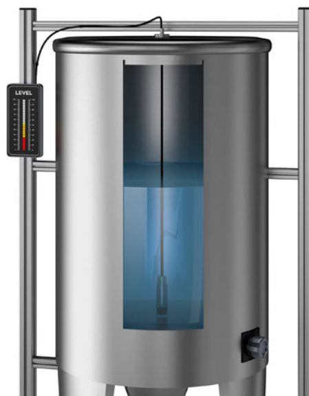
Die hydrostatischen Drucksensoren (hier eine „hängende Montage“ in einem Behälter) von IPF verfügen über Schutzklasse IP68 und sind für Medientemperaturen von -20° C bis +70° C geeignet.
