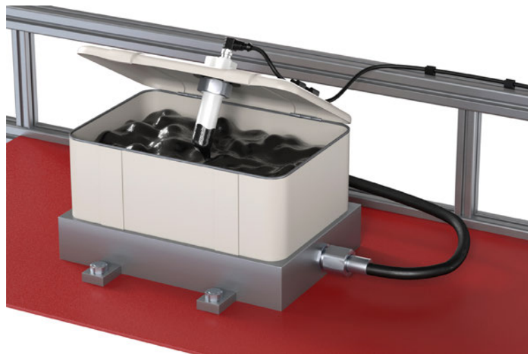
Kapazitiver Sensor FK920420 zur Kontrolle des Füllstandes in einem Behälter, in dem sich Graphitpaste zur Permanent schmierung eines Werkzeuges befindet.
