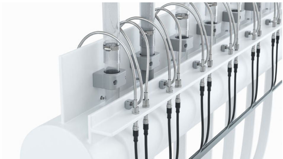
Unterbricht schon eine sehr geringe Eintrübung des Kühlmediums eine Lichtschranke, erzeugt der entsprechende Auswertekanal am Multiplexverstärker ein Schaltsignal.
