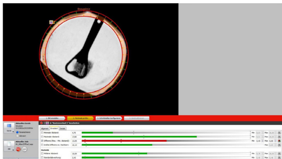
Zusätzlich zur Lage des Verschlusses erfolgt die Prüfung der Ovalität des Kronkorkens mithilfe eines vordefinierten Differenzwertes.
