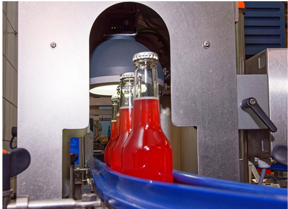
Die Prüfstation innerhalb der Abfüllanlage. Beleuchtung und Kamera befinden sich zum Schutz in einer Umhausung.
