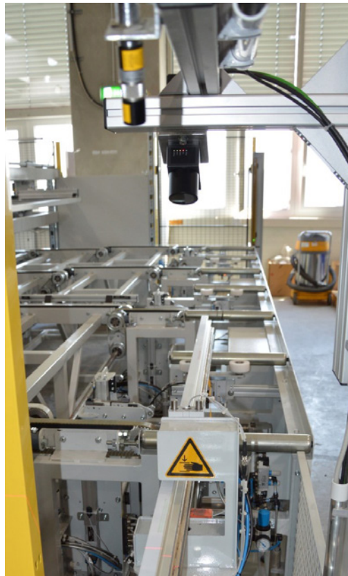
Kamerasensor und Linienlaser sind oberhalb einer Rollenbahn montiert, auf dem sich Profile aus der Vorverarbeitung befinden.
