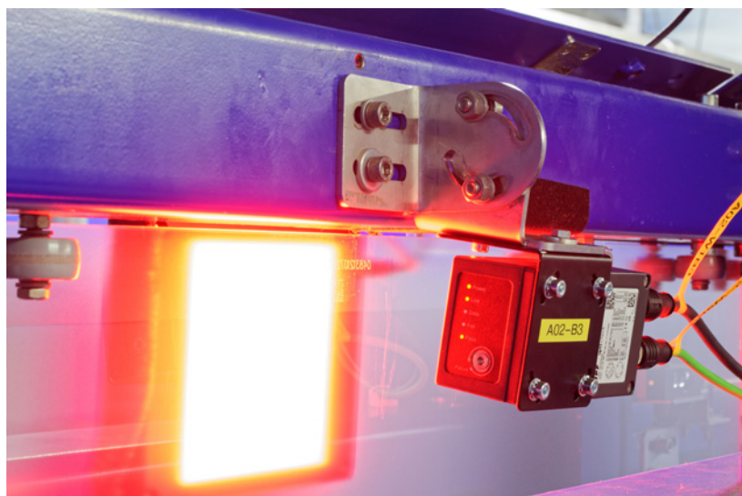
Einer der Kameras im Einsatz. Aufgrund von Durchlicht als Beleuchtungstechnik beeinflussen störende Reflexionen oder die Qualität der Beschriftung nicht mehr die zuverlässige Erkennung des Codes.
