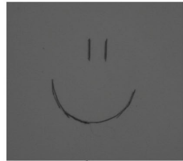
Kratzer auf einer Plexiglasscheibe. Links: Bei einer Dunkelfeld-Durchlichtbeleuchtung treten die Artefakte als helle Bereiche deutlich hervor. Rechts: Hellfeld-Durchlichtbeleuchtung.
