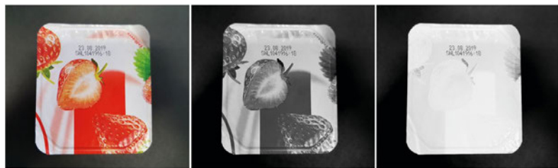
Farbaufnahme (links) und Aufnahme eines Joghurtbechers mit einer Monochromkamera unter Weißlicht (Mitte). Mit Infrarotlicht wird das farbige Design bis auf die schwarze Beschriftung nahezu vollständig ausgeblendet (rechts).
