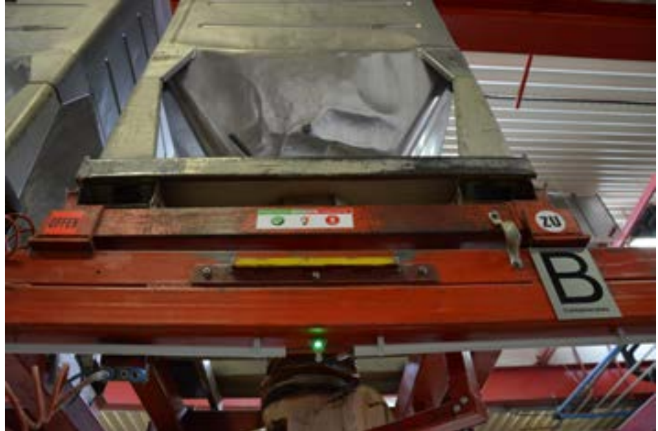
Einfache, kompakte und zielführende Lösung: Unterhalb der Rohmaterialbehälter befinden sich die LED-Bicolor-Leuchten. Ein grünes Licht signalisiert dem Staplerfahrer den auszutauschenden Rohmaterialbehälter.
