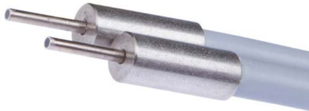
Abb. 3: Die Lichtleiterschranke LS030101 von ipf electronic vermittelt einen Eindruck von der Größe eines Glasfaser-Lichtleiters. Die Tastköpfe ganz vorne haben einen Durchmesser von nur 1,5mm. Das Faserbündel selbst verfügt über einen Durchmesser von 1mm.
