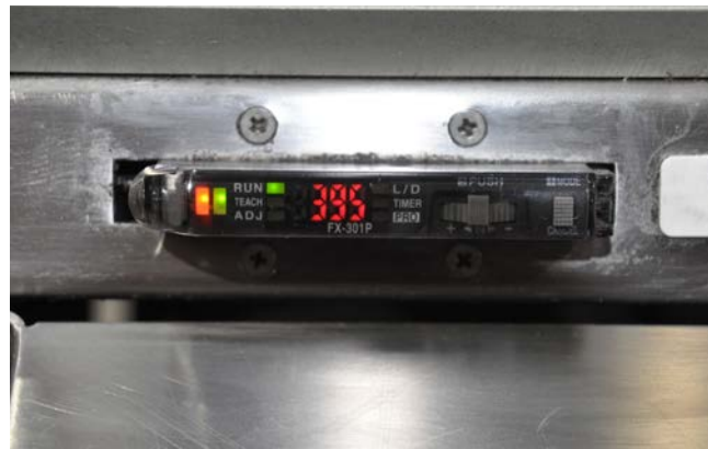
Abb. 8: Detailansicht des Verstärkers. Der angezeigte Wert gibt die Signalstärke der Lichtschranke bei Unterbrechung des Lichtsignals wieder.
