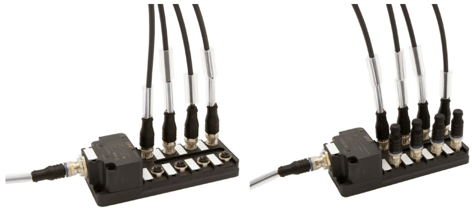
Simulationsstecker für freibleibende Steckplätze bei UND-Verknüpfungen (rechts), sind bei IO-Link-Logikverteilern (links) nicht mehr erforderlich.
