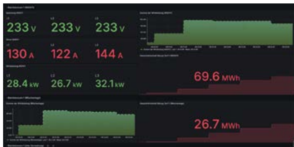
Aktuálně naměřené hodnoty z měřiče pro specifický provozní rozsah napětí, proudu, činného výkonu, jakož i celkové činné energie a celkového činného výkonu systému jsou přehledně zobrazeny na řídicím panelu.
