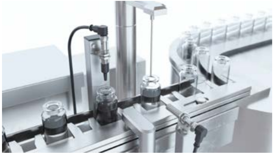
UT129021 s analogovým výstupem pro detekci výšky hladiny ve sklenicích s velmi malými otvory (vlevo). Další senzor (UT129520) s digitálním spínacím výstupem se používá pro detekci přítomnosti (vpravo).
