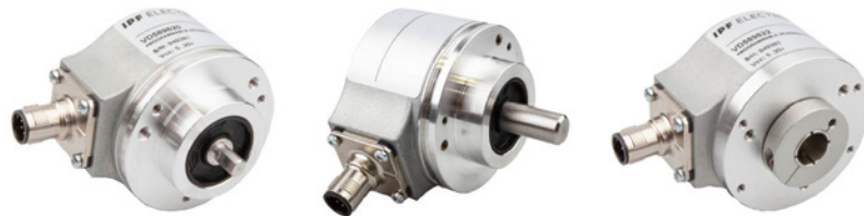
Vor Ort parametrierbar: Beispiele für die inkrementalen Drehgeber von ipf electronic. Von links: VD589820 mit 6mm-Vollwelle, VD589821 mit 10mm-Vollwelle und VD589822 mit 12mm-Hohlwelle.
