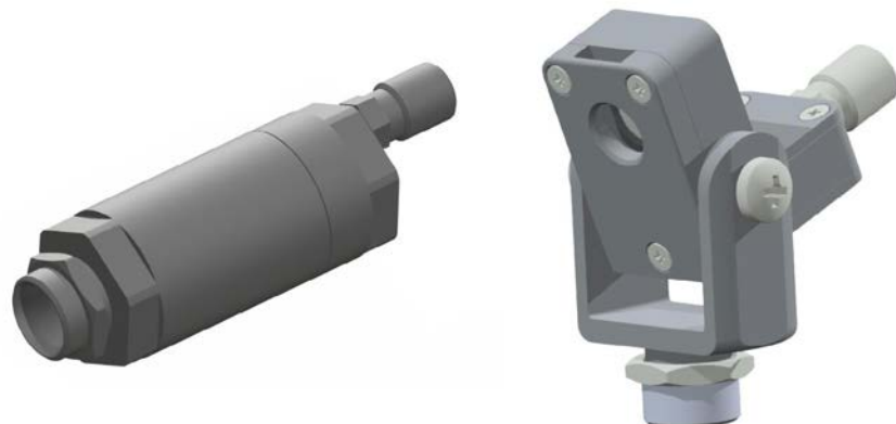
Abb. 5: Um eine Verschmutzung der Optiken zu vermeiden, können entweder Freiblasvorsätze in Standardausführung (links) oder mit seitlichem Luftaustritt eingesetzt werden. Die Lamina-Freiblasvorsätze (rechts) verhindern bei kleinen Messabständen ein Herunterkühlen des Objektes.
