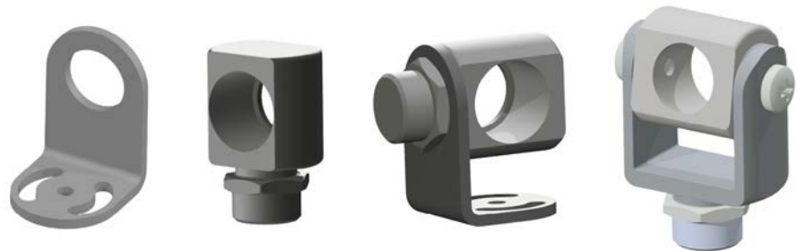
Abb. 4: Zur Montage der Messköpfe für die zweiteiligen Systeme steht eine Reihe an Zubehör zur Verfügung. Links: ein Montagewinkel und daneben ein Montagebolzen (jeweils justierbar in einer Achse) sowie die Kombination beider Lösungen (justierbar in zwei Achsen). Ganz rechts: eine Montagegabel, die sich ebenfalls in zwei Achsen justieren lässt.
