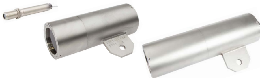
Abb. 2: Auswahl an kompakten optischen Temperatursensoren (von links): der OI12C758 mit einem Messbereich bis +1030° C, der OI810143 (Messbereich bis +300° C) und der OI810142 (Messbereich bis +750° C).
