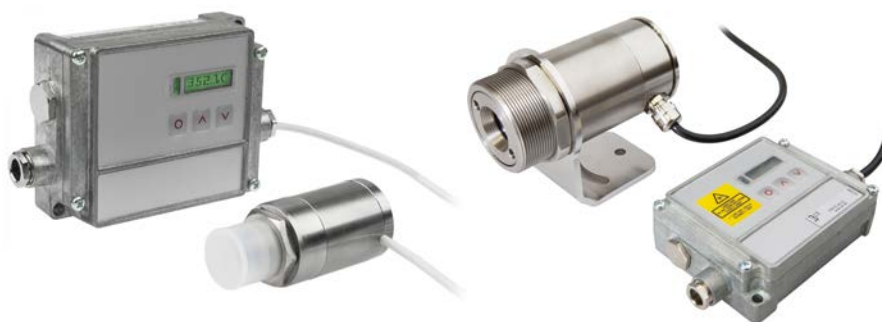
Abb. 3: Der Messkopf des OI98E239 (Messbereich -40° C bis +975° C) ist für Umgebungstemperaturen von bis zu +250° C ausgelegt (links). Der Messbereich des OI98E240 (rechts) erstreckt sich von +385° C bis +1600° C.
