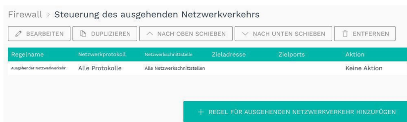
Firewall>Steuerung des ausgehenden Netzwerkverkehrs (Beispiel)
